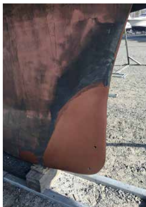
Kölsidorna på Bavaria 33 optimerades med ett elastiskt spackel. Resultatet efter varvsjobbet blev lyckat; båten seglar numera lika på bägge halsar och tar bättre höjd på kryss.
