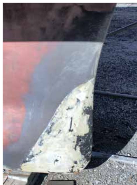
En Bavaria 33 Cruiser är utrustad med ett gummikölskydd. Spacklingen mellan järnkölen och kölskyddet är inte gynnsam. Bland annat är kölsidorna inte symmetriska.
