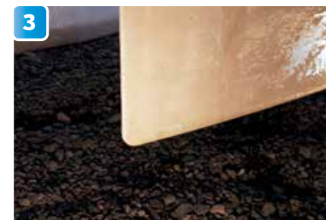
Den färdiga lamineringen på bakkanten av kölen.
