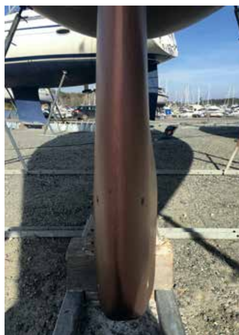
Kölsidorna på Bavaria 33 optimerades med ett elastiskt spackel. Resultatet efter varvsjobbet blev lyckat; båten seglar numera lika på bägge halsar och tar bättre höjd på kryss.
