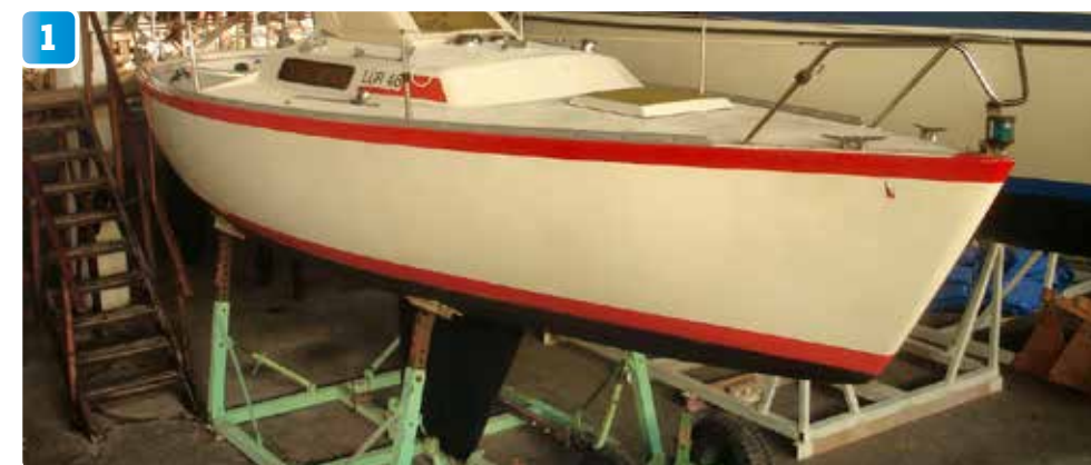
En köl på en Albin Express har ett djupgående på 1,45 meter. I projektet ska originalkölen få en bättre kölprofil.
