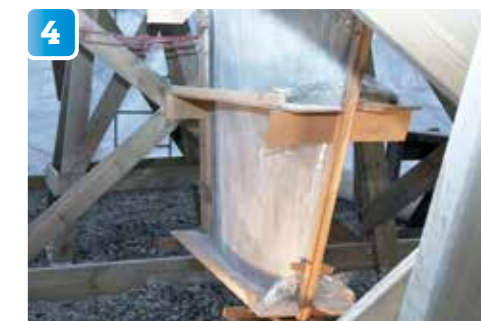
Sex kölmallar, tre på varje kölsida, tillverkas utifrån en ritning som finns på internet. Innan mallarna sätts på plats i höjddled på kölsidorna appliceras en sträng NM Spackel 205. För att mallarna inte ska fastna för hårt när de trycks dit skyddas de med plastfolie.
